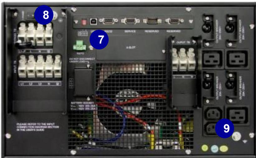
**7. Встроенный USB-порт и X-слот помогают при управлении и мониторинге работы ИБП**
