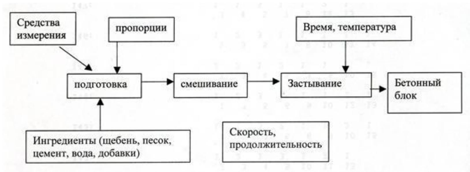
Диаграмма изготовления бетонного блока
