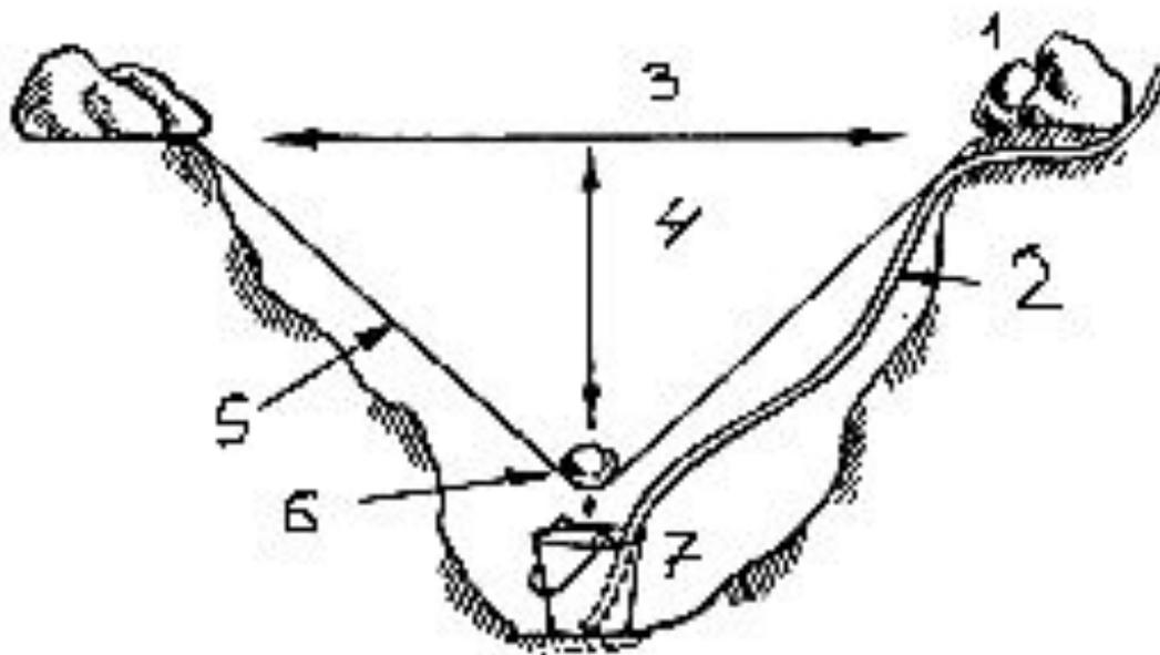
„Перегонное“ устройство: 1 — втулка, прижимающая пластик; 2 — трубка для питья воды; 3 — диаметр ямы около 1 м; 4 — высота около 0,5 м; 5 — пластик; 6 — камень; 7 — ведро.
