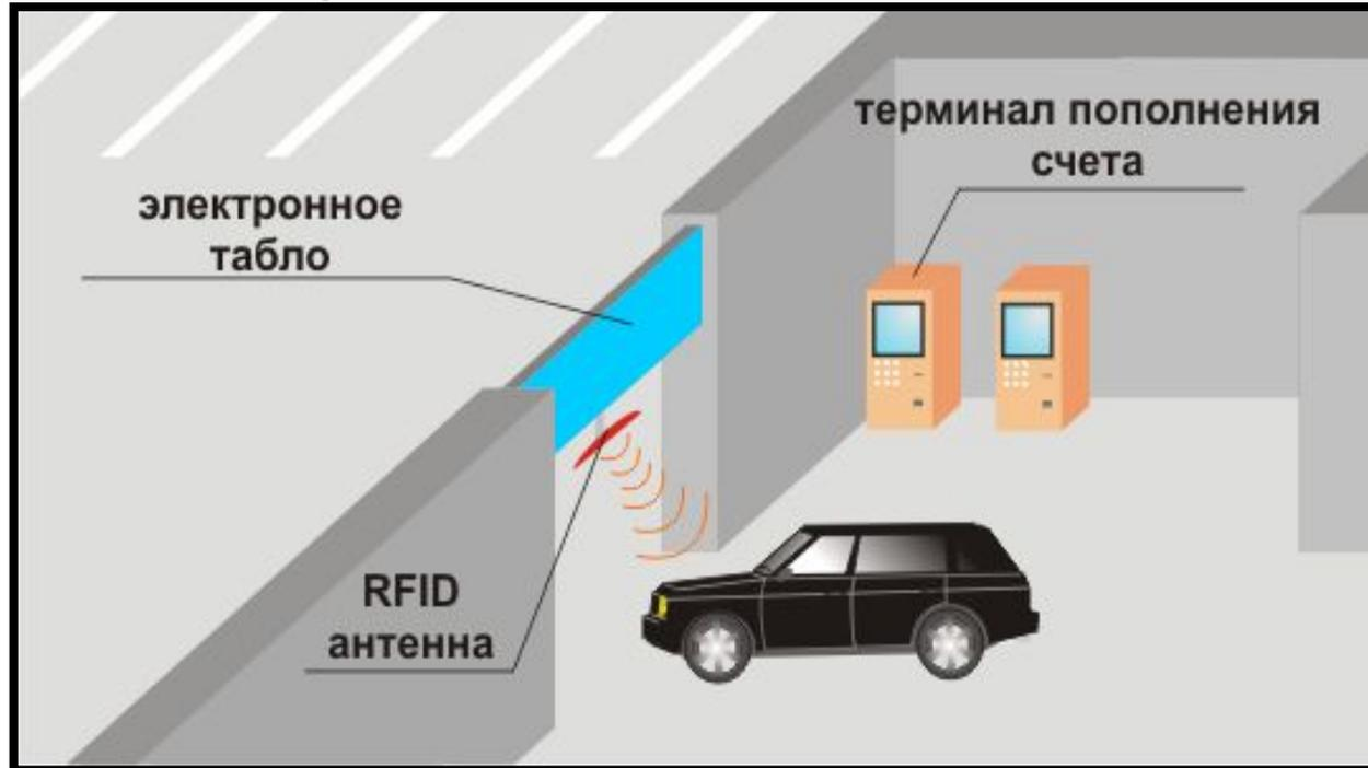
При помощи киосков экспресс оплаты водитель может пополнить свой счет прямо на стоянке.
