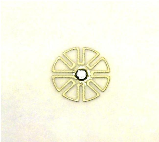
**Для маркировки пломб разработана специальная сверхмалая метка, способная работать будучи заглубленной в тело метки на глубину до 3-5 мм. Размеры метки (диаметр менее 5 мм) позволяют встраивать ее во все в настоящее время имеющиеся на железной дороге виды пломб.**
