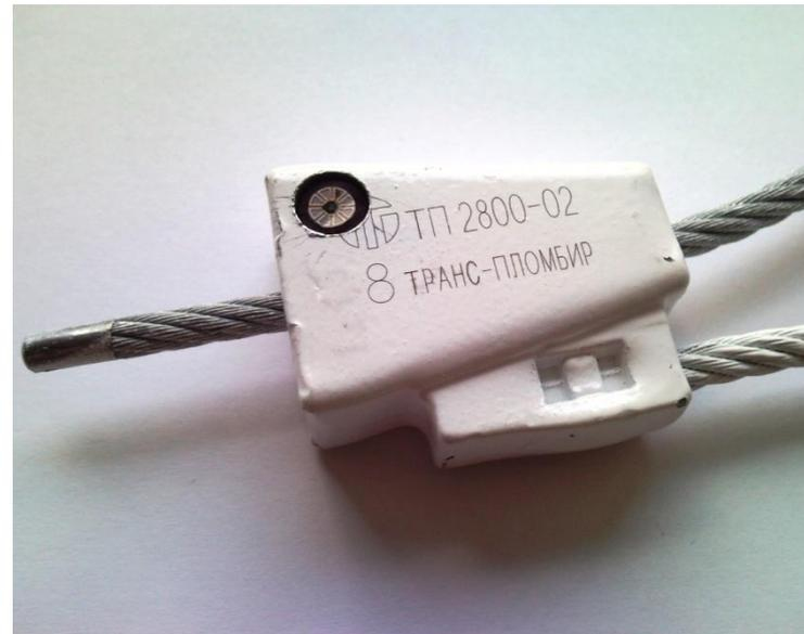
**Метка закладывается в углубление в пломбе на глубину от 3 до 5 мм и заливается специальным компаундом. Способ закрепления метки исключает возможность ее извлечения без разрушения. Для чтения информации с метки пломбы используется специально разработанный считыватель-щуп**
