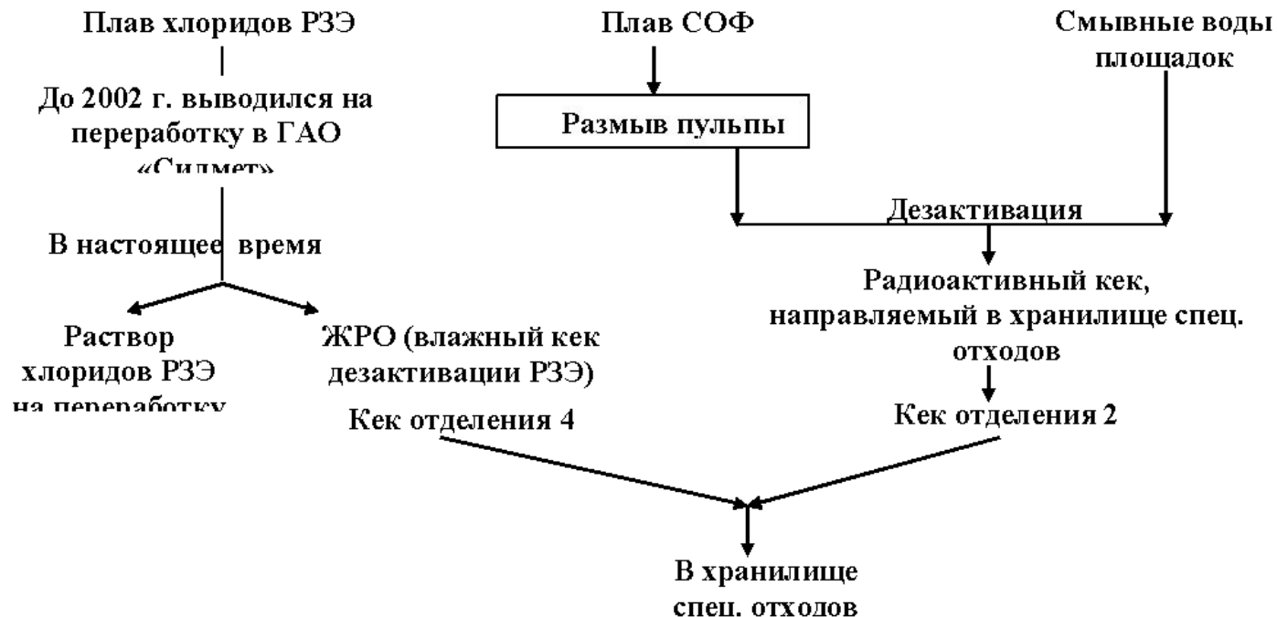
Принципиальная схема переработки плава хлоридов РЗЭ
