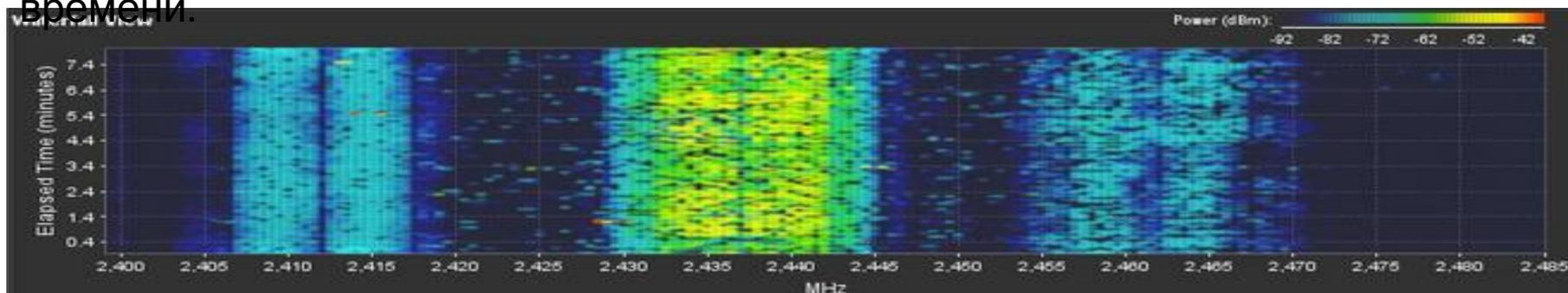
1. Динамический график энергии частот. Показывает зашумление сигнала в dBm во всем диапазоне 2.4GHz с периодом 260 мс.
