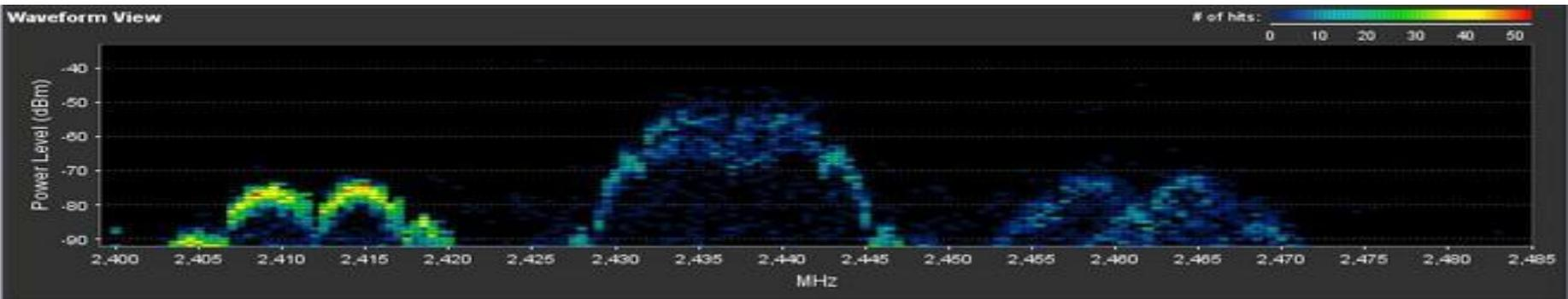
3. Динамический график совокупной энергии. Имеет цветовую расшифровку. Спектр определяется от темно-синего (чистый канал) до красного («зашумленный» канал).
