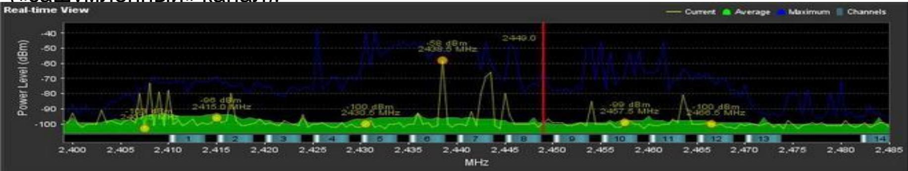
4. Традиционный график анализа спектра. Имеет три линии: Максимальная задержка, этот показатель обновляется и фиксирует максимальный уровень мощности на частоте с самого начала работы AirView. Average – показатель текущей средней энергии сигнала на заданной частоте. Current (реальное время) – показатель энергии в реальном времени, замеченный устройством AirView как производная частоты.
