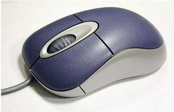
**МЫШЬ** – это удобное устройство (манипулятор), с помощью которого можно управлять объектами в графической операционной системе.
