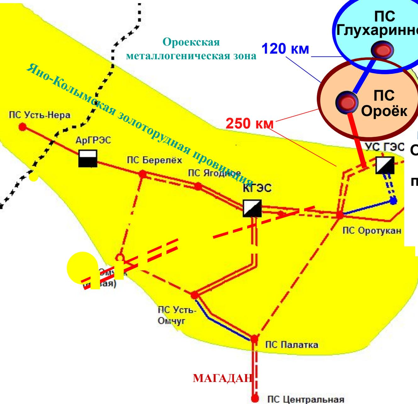
ВЛ 110 кВ «Ороек - Глухаринное» с ПС 110 кВ «Глухаринное» протяженностью 120 км с трансформатором 2x16 МВА.
