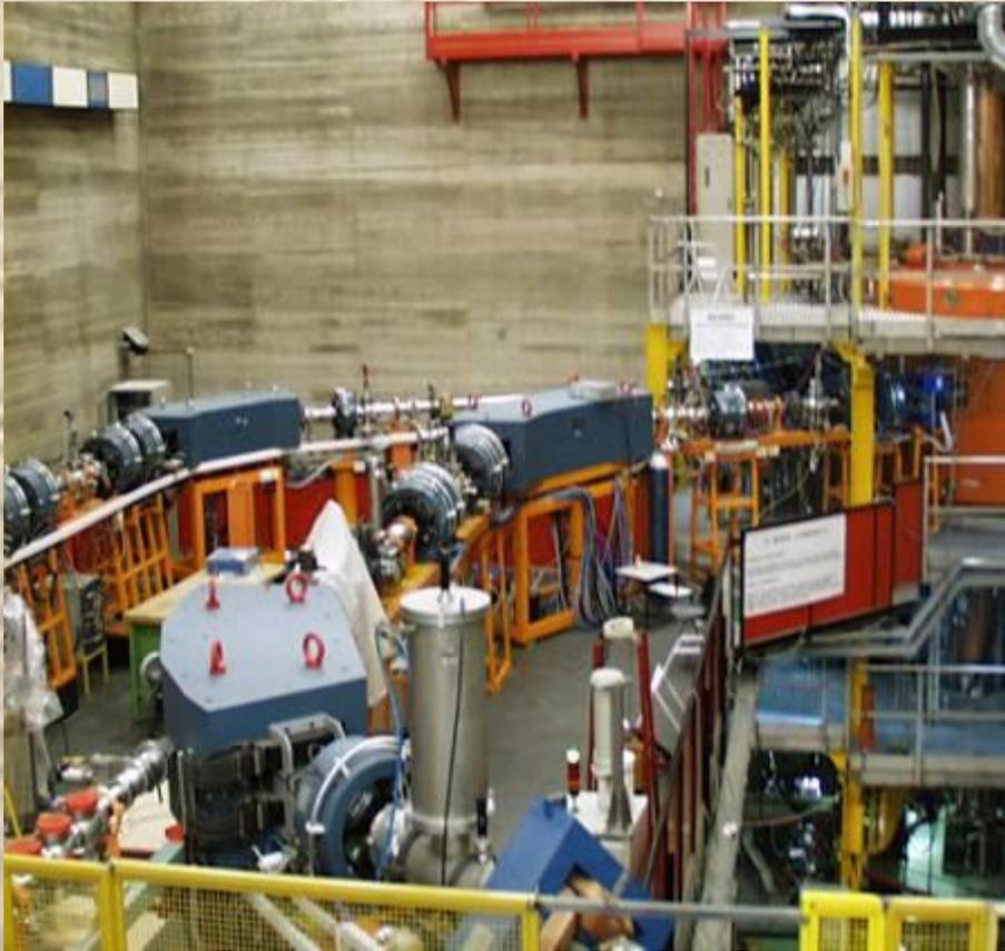
Один из первых ускорителей частиц, в основном положительных ионов. Частицы ускоряются переменным электрическим полем, закручиваясь вокруг линий магнитной индукции, под действием силы Лоренца.
