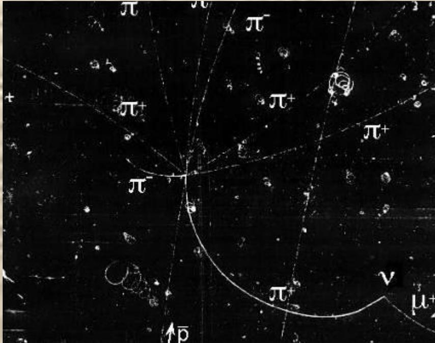
Поток элементарных частиц, пролетая через фотоэмульсионный слой, оставляет следы, которые можно увидеть после проявления пленки. Анализируя треки этих следов, можно судить о видах частиц, которые содержатся в пучке.
