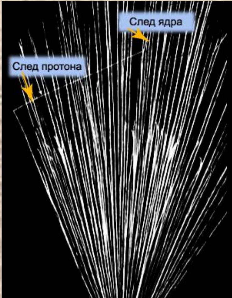
Прибор, предназначенный для исследования элементарных частиц. По длине траектории, оставленной частицей внутри камеры можно судить о ее скорости и массе. Во время эксперимента внутреннее пространство камеры снимается на фотопленку.
