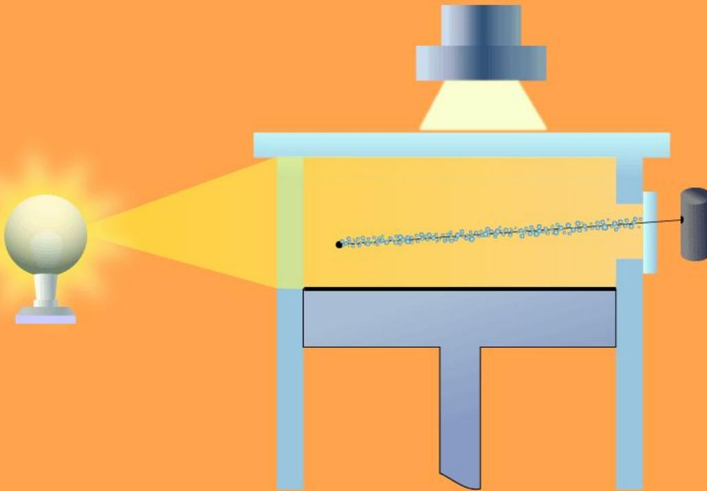
Представляет собой герметическую камеру, заполненную перенасыщенным паром. Частицы пролетая через камеру, вызывает конденсацию пара вдоль своей траектории. Оставшийся след фотографируется через стеклянную стенку камеры.
