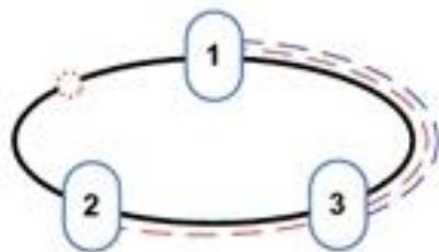
В стандартной топологии «кольцо» с тремя узлами (рис. 1) порты узлов соединяются так, что бы получилось 3 участка сети: 1-2, 2-3, 3-1. При разрыве на одном из участков сети, все узлы соединяются по «запасному» маршруту. Например, при разрыве на участке 1-2, данные будут передаваться по направлению 1-3-2
