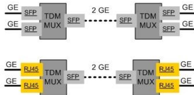
Мультиплексирование 2-х каналов передачи данных до 1,25 Гбит/с в 1 оптический канал до 2,5 Гбит/с
