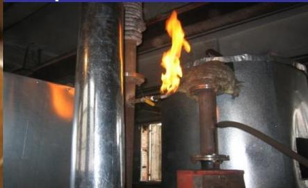
**3. Пиролизный газ - газовая смесь ( $\text{CH}_4$ ,  $\text{C}_n\text{H}_n$ ,  $\text{H}_2$ ,  $\text{CO}$ ,  $\text{CO}_2$ ,  $\text{O}_2$ ...) с теплотой сгорания до 24 МДж/м<sup>3</sup> и предназначенная, для использования в энергетических системах и системах потребления газа, а также как исходное сырье для органического синтеза, с целью получения химических продуктов.**
