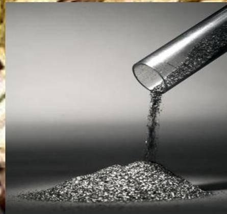
**2. Высокоуглеродистый материал (ВУМ) – твердое углистое вещество (с содержанием чистого углерода до 90%), предназначено для использования в металлургии (взамен кокса), химической, шинной и пищевой промышленности, медицине (аналог активированным углям), в системах ЖКХ и энергетики (как высококалорийное топливо более 7 000 ккал/кг).**
