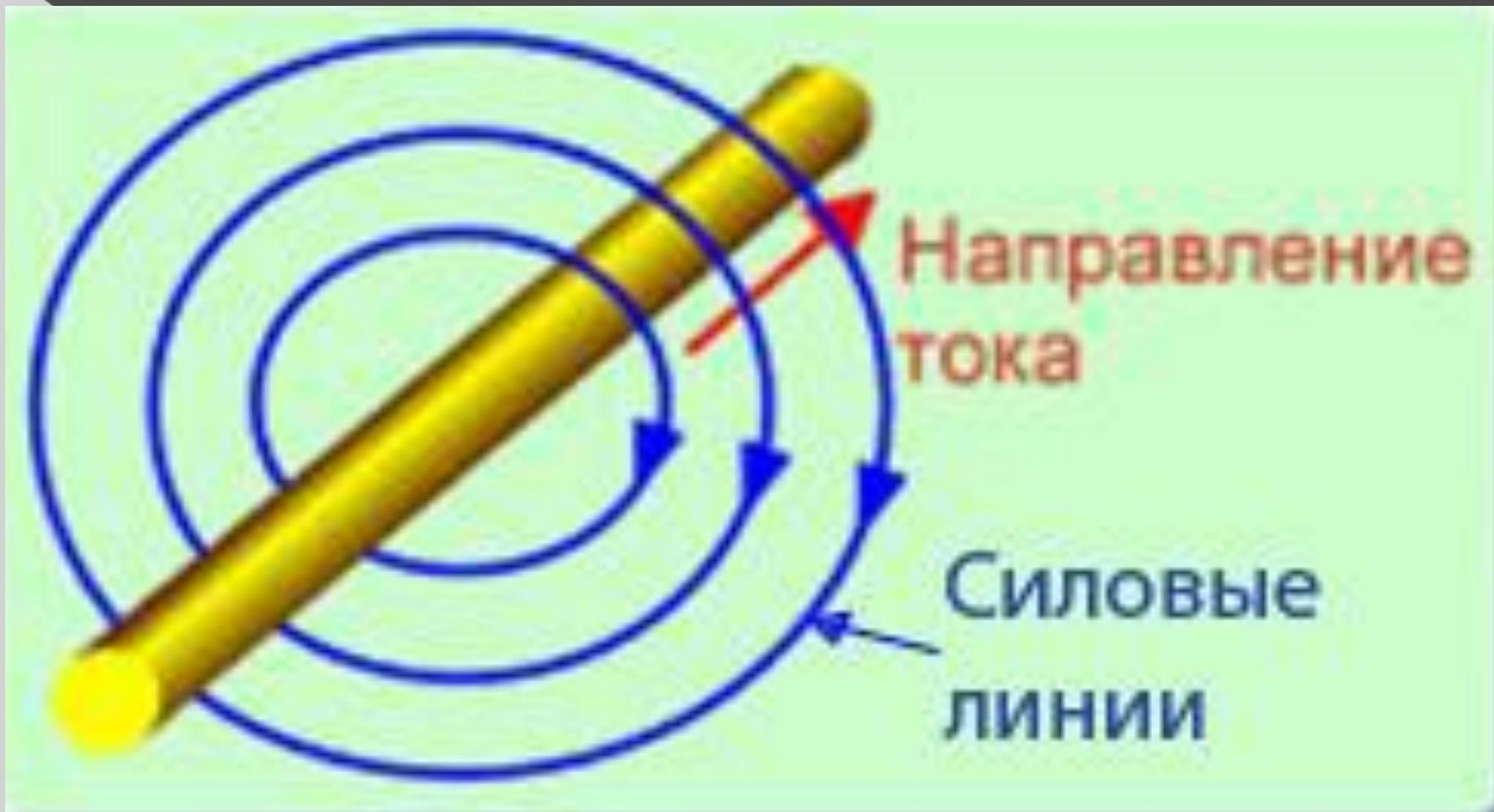
Силовые линии вокруг проводника
