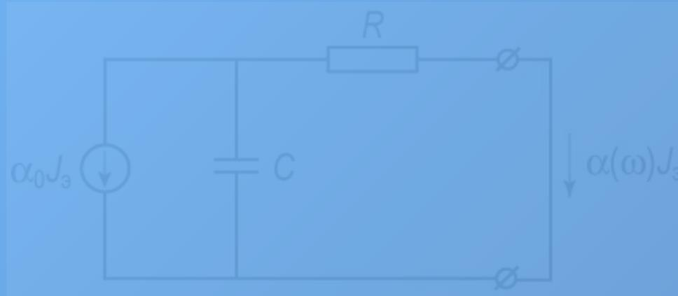
Если входной переменный сигнал  $\alpha_0 I_3$ , то ток в цепи резистора будет отображать АЧ- и ФЧ-зависимости  $\alpha_0(\omega) I_3$ .
