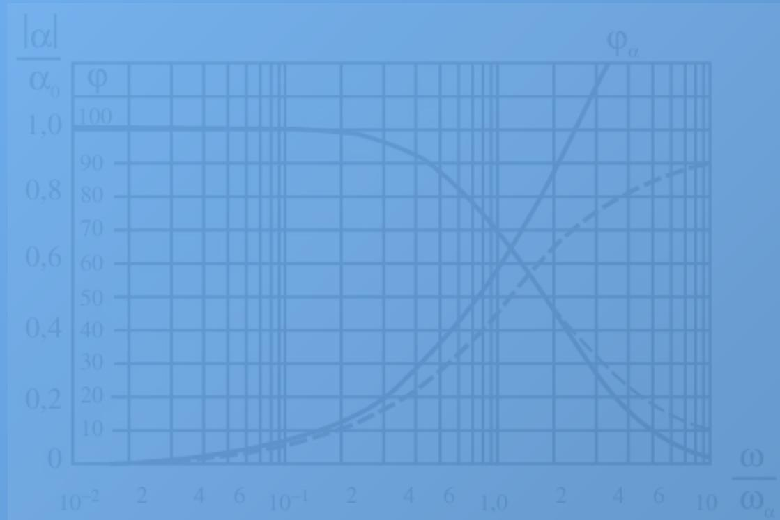
Для представления в эквивалентных схемах амплитудной и фазочастотной зависимостей  $\alpha(\omega)$  используют RC-цепочку:
