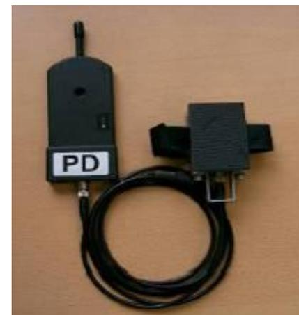
Радиопередача данных осуществляется на приемную электронику (1 987 009C1RN) и далее по кабелю поступает на управляющую плату шкафа управления тормозного стенда.
