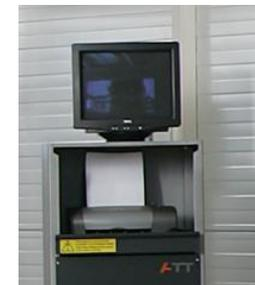
Компьютерная стойка с программным обеспечением обеспечивают контроль и отражение всего технологического процесса (диагностика тормозов, подвески, увода, веса, усилия на педали тормоза).
