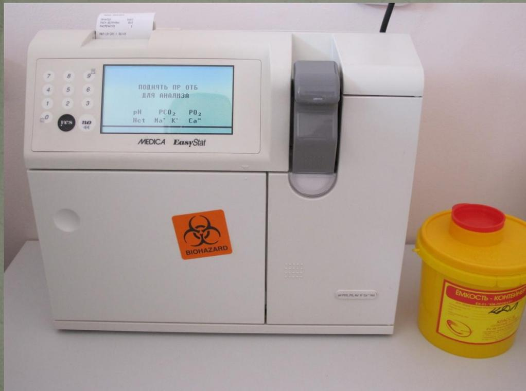
Экспресс-анализатор параметров критического состояния (газы крови, электролиты, КЩС)
