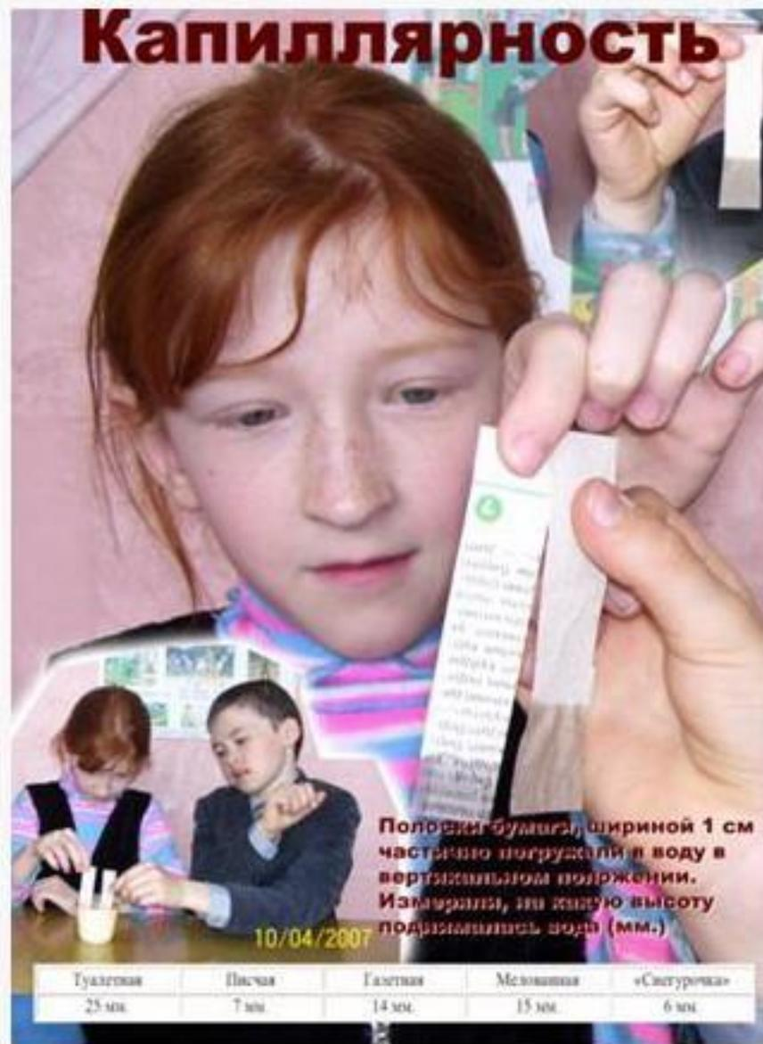
Полоски бумаги, шириной 1 см частично погружали в воду в вертикальном положении. Измерили, на какую высоту поднималась вода (мм.)
