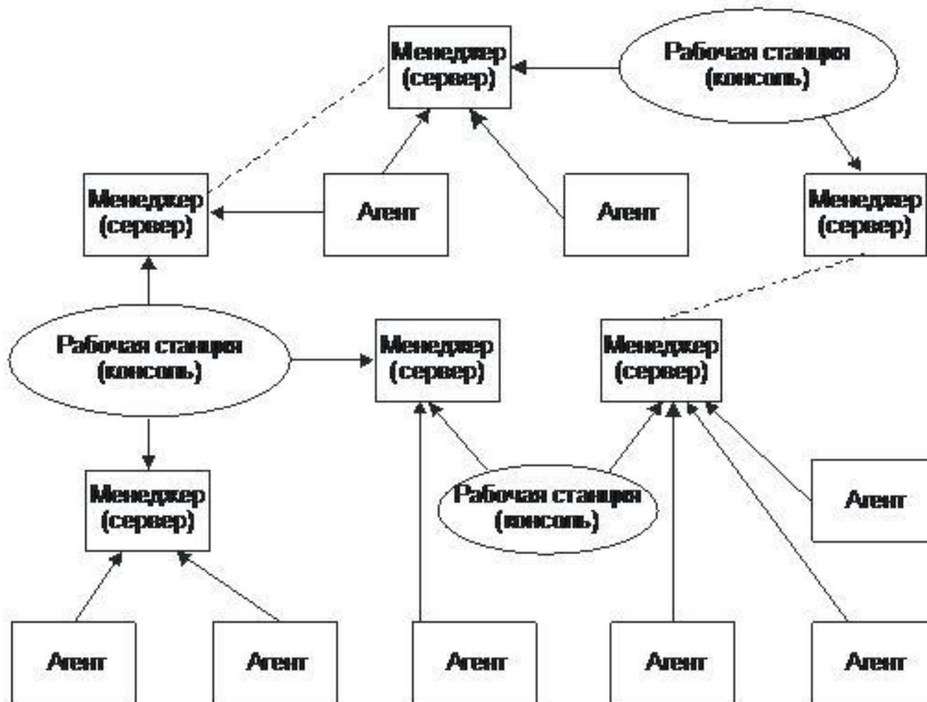
**Рис. 22.17.** Распределенная система управления на основе нескольких менеджеров и рабочих станций
