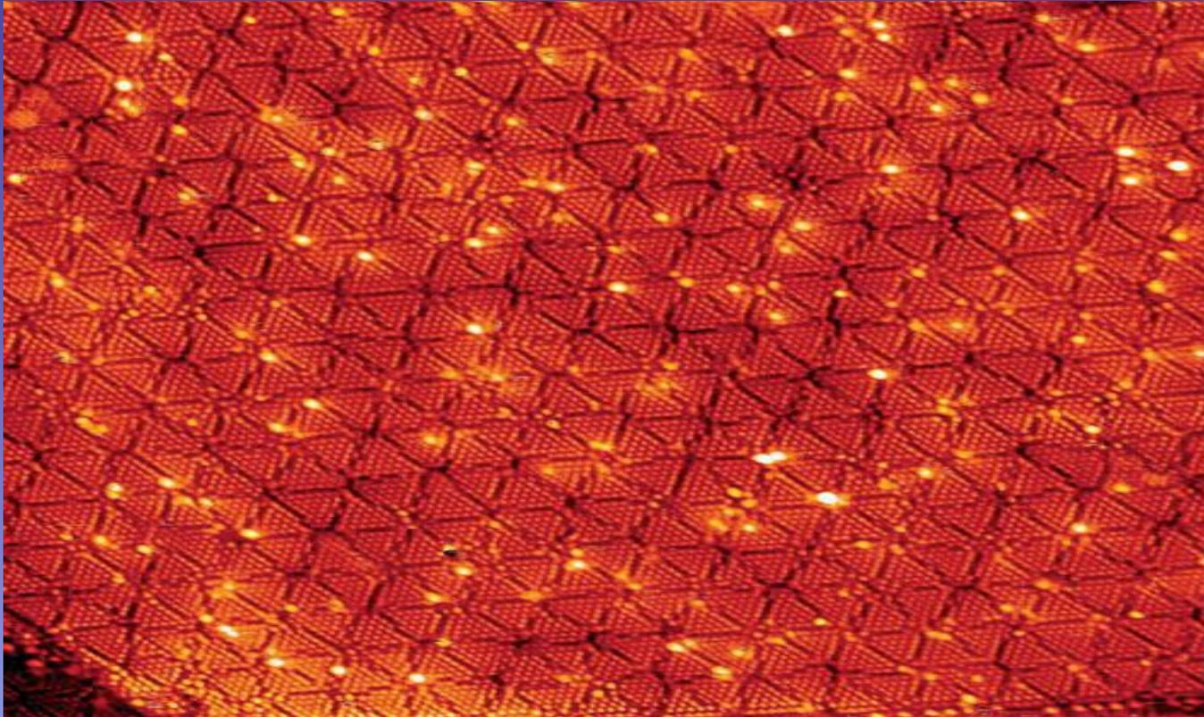
Так выглядит слой алюминия на поверхности кремния на изображении, полученном с помощью СТМ в Отделе физики поверхности ИАПУ ДВО РАН. Из-за того что атомы алюминия больше по размеру, чем атомы кремния, образуется такая необычная сверхструктура в виде треугольников
