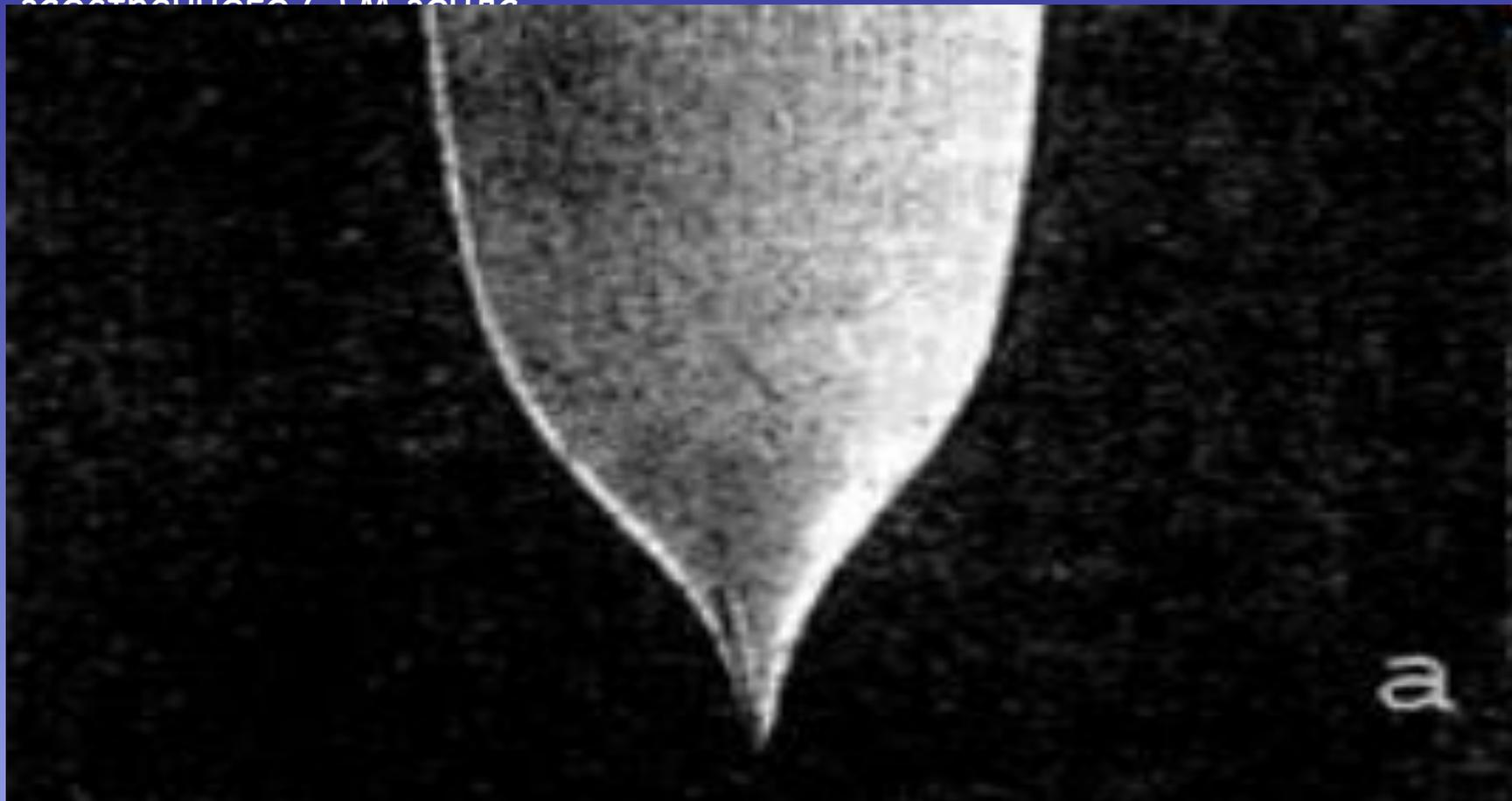
Самый важный элемент у атомно-силового микроскопа – игла. Так как мы заглядываем в наномир посредством взаимодействия между электронными оболочками атомов образца и атомов иглы.
