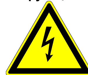
Предупреждение об опасном напряжении
