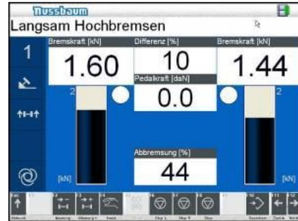
Показания монитора в процессе проверки
