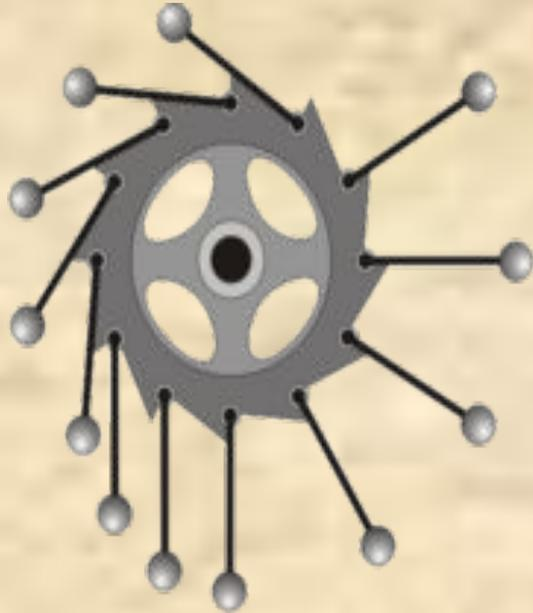
Здесь представлена одна из древнейших конструкций вечного двигателя. Она представляет зубчатое колесо, в углублениях которого прикреплены откидывающиеся на шарнирах грузы. Геометрия зубьев такова, что грузы в левой части колеса всегда оказываются ближе к оси, чем в правой. По замыслу автора, это, в согласии с законом рычага, должно было бы приводить колесо в постоянное вращение. При вращении грузы откидывались бы справа и сохраняли движущее усилие.
