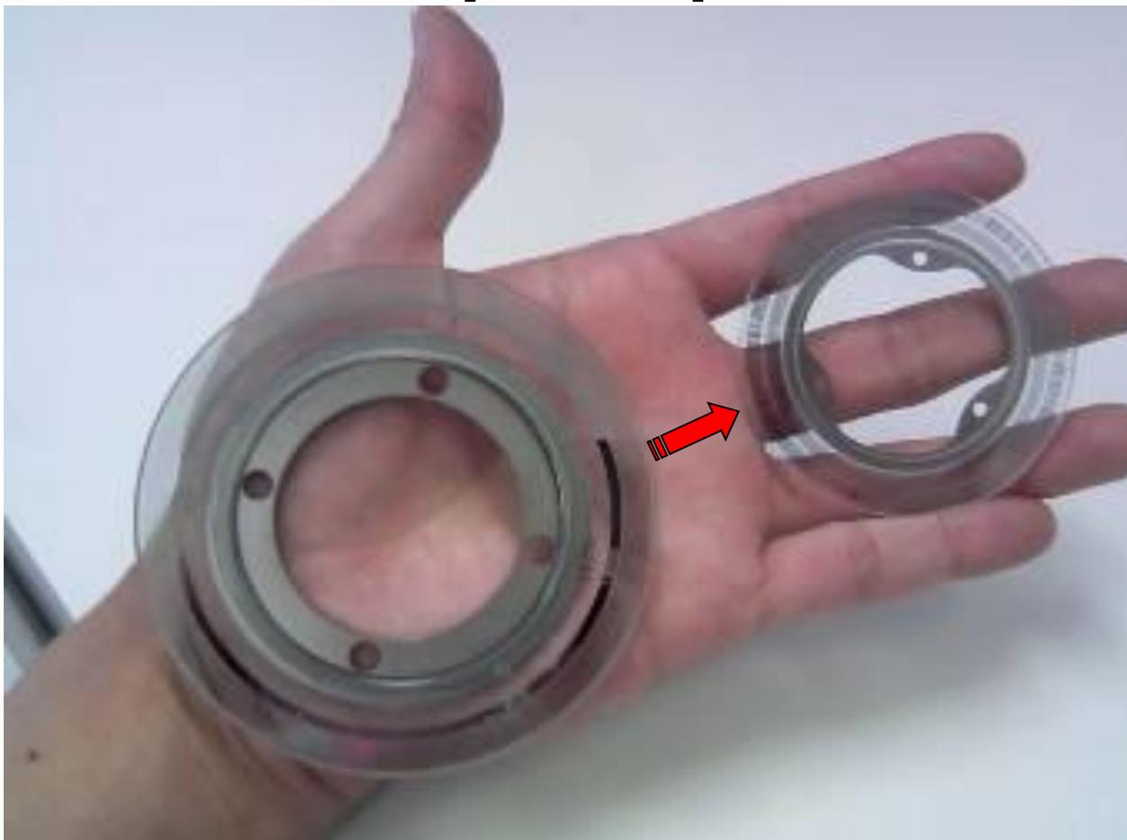
Диаметр лимба уменьшен с 80 мм до 62 мм
