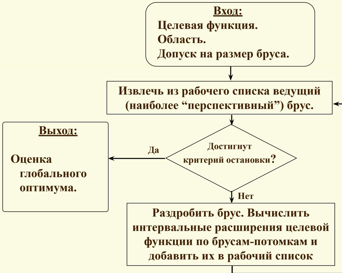
**Блок-схема оптимизационного алгоритма адаптивного интервального дробления**
