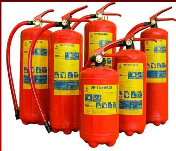
Огнетушители переносные порошковые (ОП), в зависимости от марки используемого огнетушащего порошка, предназначены для тушения пожаров классов А (твёрдые горючие вещества), В (жидкие горючие вещества), С (газообразные вещества) и электроустановок, находящихся под напряжением до 1000 В. При использовании огнетушащего порошка ПХК и специального оборудования огнетушители переносные порошковые применяются для тушения пожаров класса Д (металлы и металлоорганические вещества).
