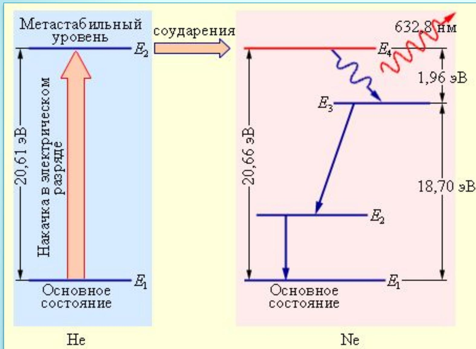
Механизм накачки He–Ne лазера. Прямыми стрелками изображены спонтанные переходы в атомах неона
