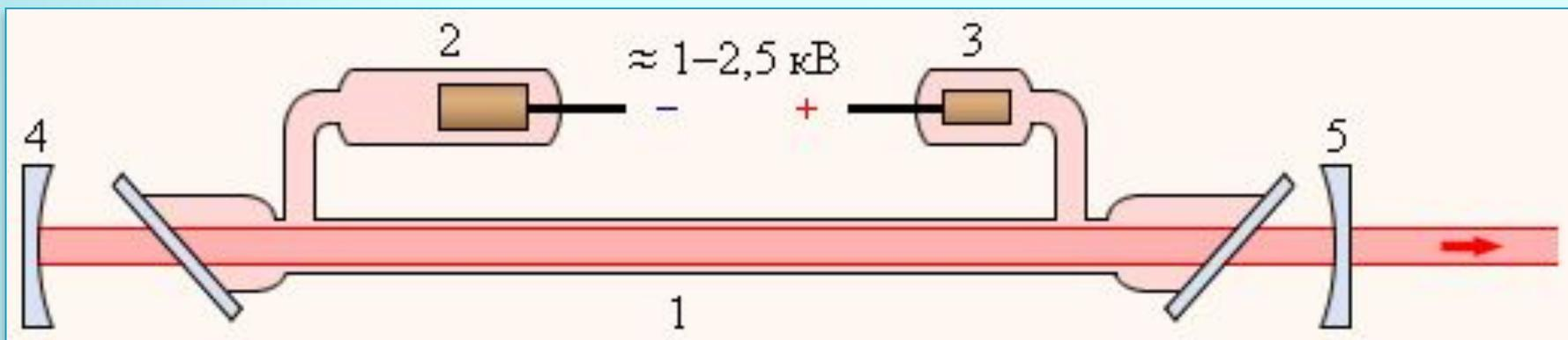
Схема гелий-неонового лазера: 1 – стеклянная трубка со смесью гелия и неона, в которой создается высоковольтный разряд; 2 – катод; 3 – анод; 4 – глухое сферическое зеркало с пропусканием менее 0,1 %; 5 – сферическое зеркало с пропусканием 1–2 %
