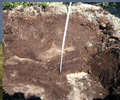
Структура оседания при протаивании сильно льдистых грунтов террасе
