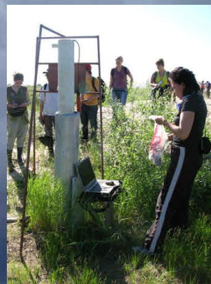
Термометрические исследования в скважине с использованием терморезисторов и пример графической обработки данных
