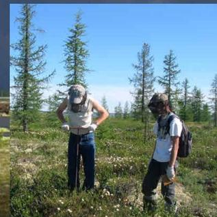
Измерение глубины сезонного оттаивания грунтов с помощью мерзлотного щупа
