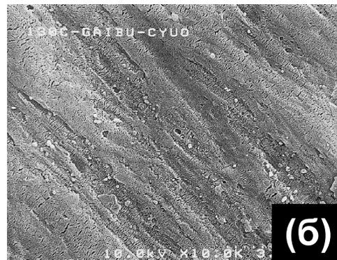
Сканирующая электронная микроскопия полиэтиленового слоя до (а) и после (б) повышения температуры до 130 °С внутри ЛИА
