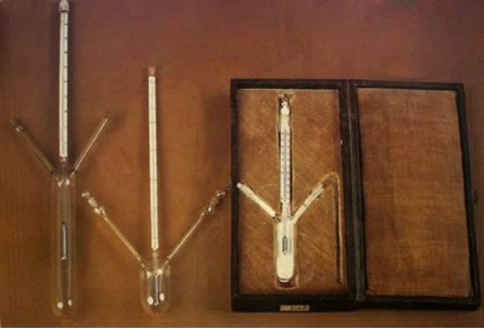
Пикнометр конструкции Д.И. Менделеева
