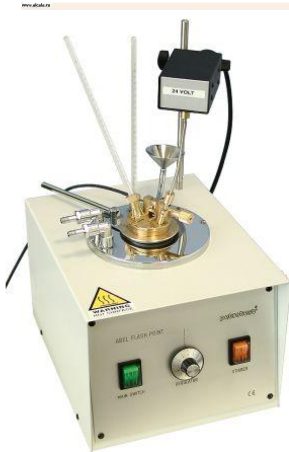
газрозъ прибор Абеля-иенского для определения вспышки керосина.
