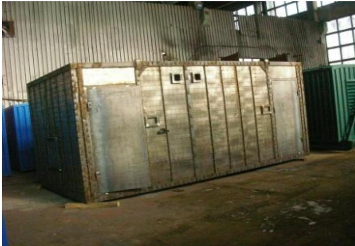
**Армирование контейнера выполняется снаружи. Нижняя рама контейнера выполнена из швеллеров, перевязанных швеллерами меньшего размера. Пол контейнера выполнен из рифленого листа толщиной 4 мм. Обшивка стен и потолка выполнена стальным профилированным листом. Изнутри поверхность стен выложена утеплителем - минеральная вата «URSA», толщиной 50 мм, и профилированным стальным листом.**
