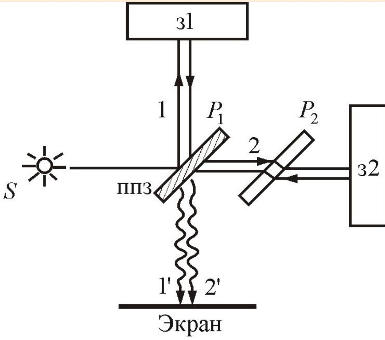
Для наблюдения полос равного наклона вместо плоскопараллельной пластиинки удобно использовать *интерферометр Майкельсона*
