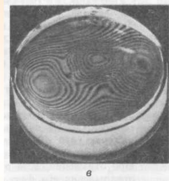
*a* - световые лучи, отражаясь от верхней и нижней поверхностей тонкого воздушного клина, интерферируют и образуют светлые и темные полосы: *б* - интерференционная картина, наблюдаемая в случае оптически плоских стеклянных пластин; *в* - интерференционная картина, наблюдаемая в случае неплоских пластин.
