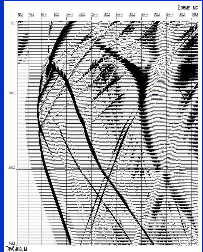
Поле, промоделированное методом конечных разностей
