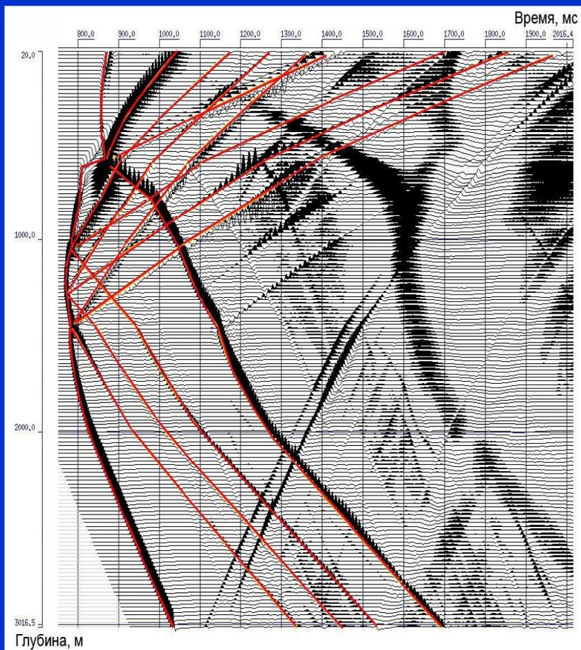
Годографы однократных волн, снятые с поля в ручную
