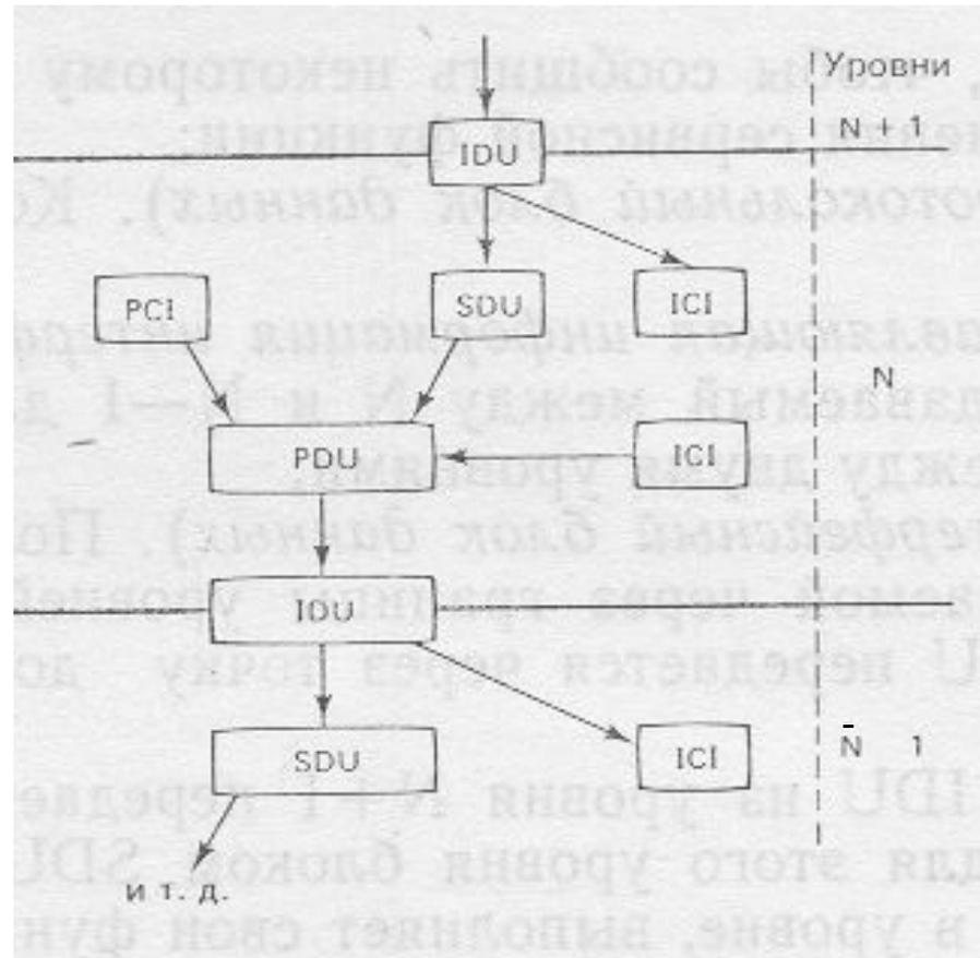
SDU — блок сервисных данных; PCI — управляющая информация протокола; PDU — блок протокольных данных; IDU — блок интерфейсных данных; ICI — управляющая информация интерфейса.
