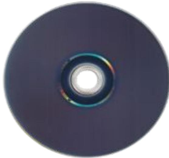
Диск Blu-ray (букв. «синий-луч») получил своё название от использования для записи и чтения коротковолнового (405 нм) «синего» (технически сине-фиолетового) лазера. Однослойный диск может хранить 23,3/25/27 или 33 Гб, двухслойный - 46,6/50/54 или 66 Гб. Единица скорости (1x) передачи информации BD составляет 4,5 Мбайт/с.
