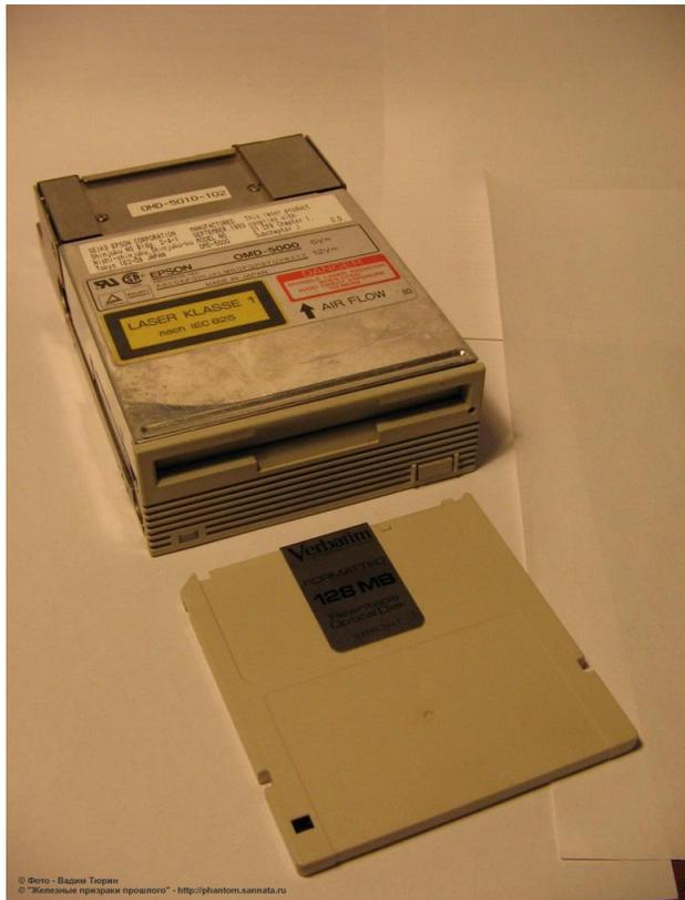
**Магнитооптический диск** (также допускается написание *магнитно-оптический диск*) — носитель информации, сочетающий свойства оптических и магнитных накопителей. Впервые магнитооптический диск появился в начале 80-х годов. Обеспечивает более высокую надёжность хранения информации благодаря одновременному воздействию на носитель двух физических процессов (оптического и магнитного).
