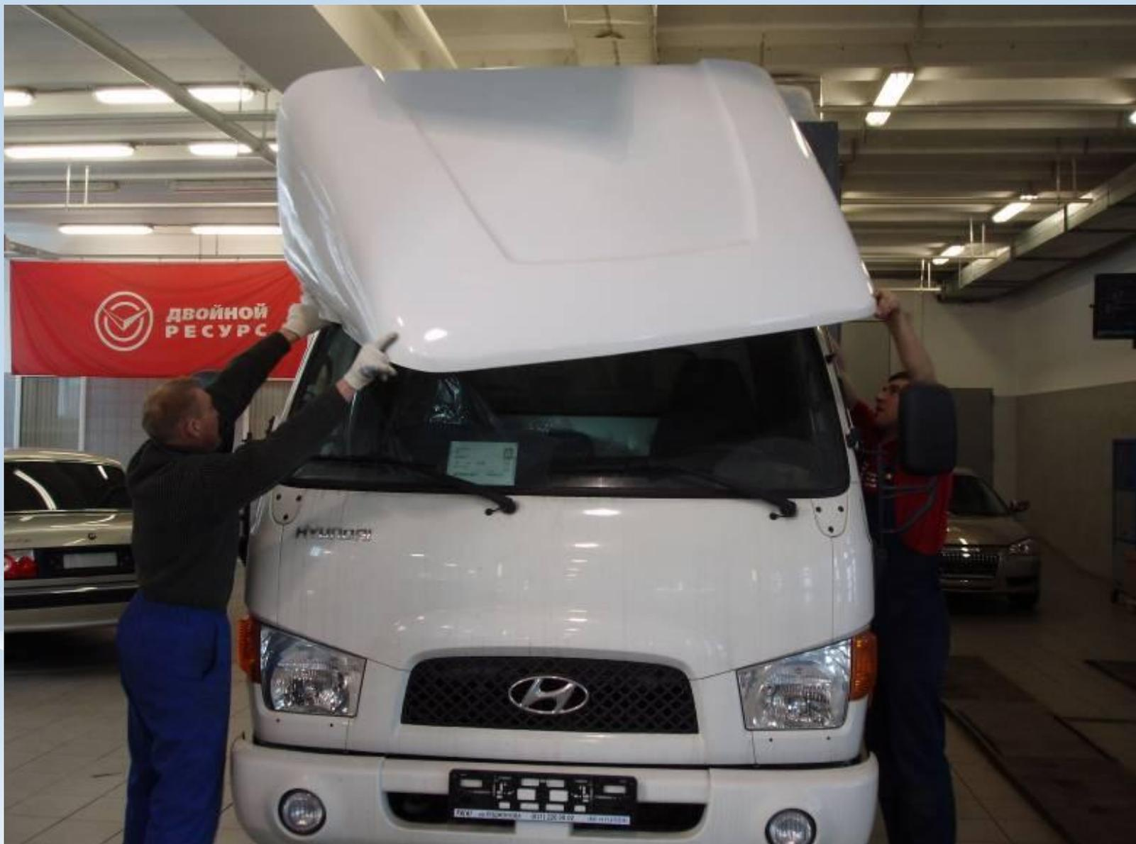
При установке обтекателя на верх, обязательно воспользуйтесь помощью напарника, что бы не оцарапать кабину машины.
