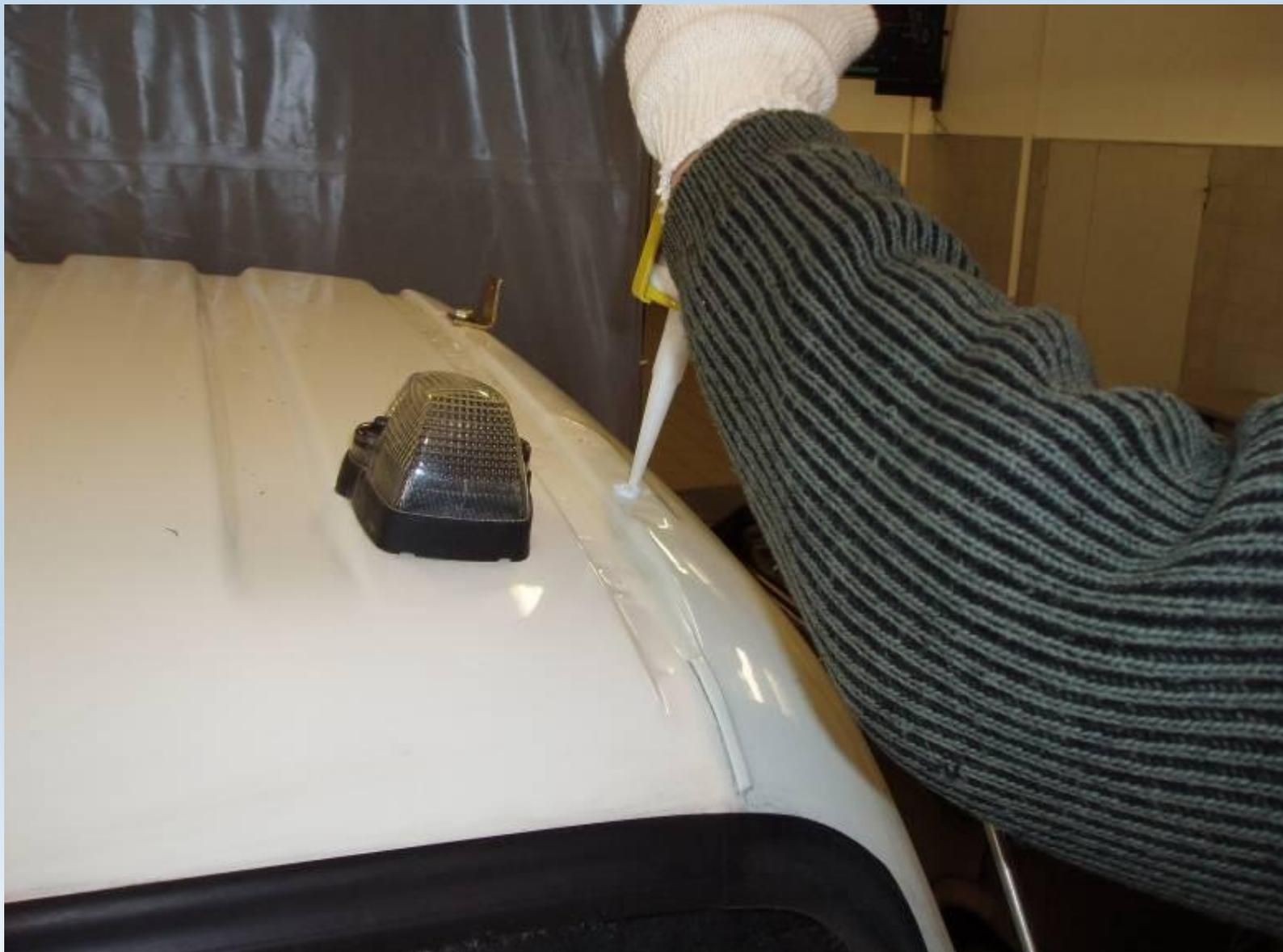
Заполните отверстия герметиком и установите крепление
