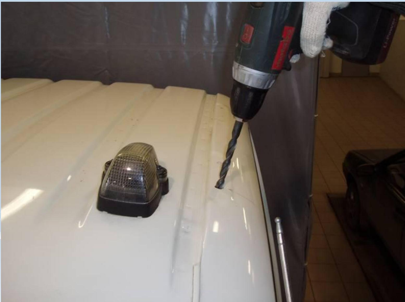
Далее сверлом 11 мм рассверлите полученные отверстия. (не нажимайте сильно, чтобы не повредить внутреннюю резьбу на закладных деталях, которые уже установлены внутри кабины)
