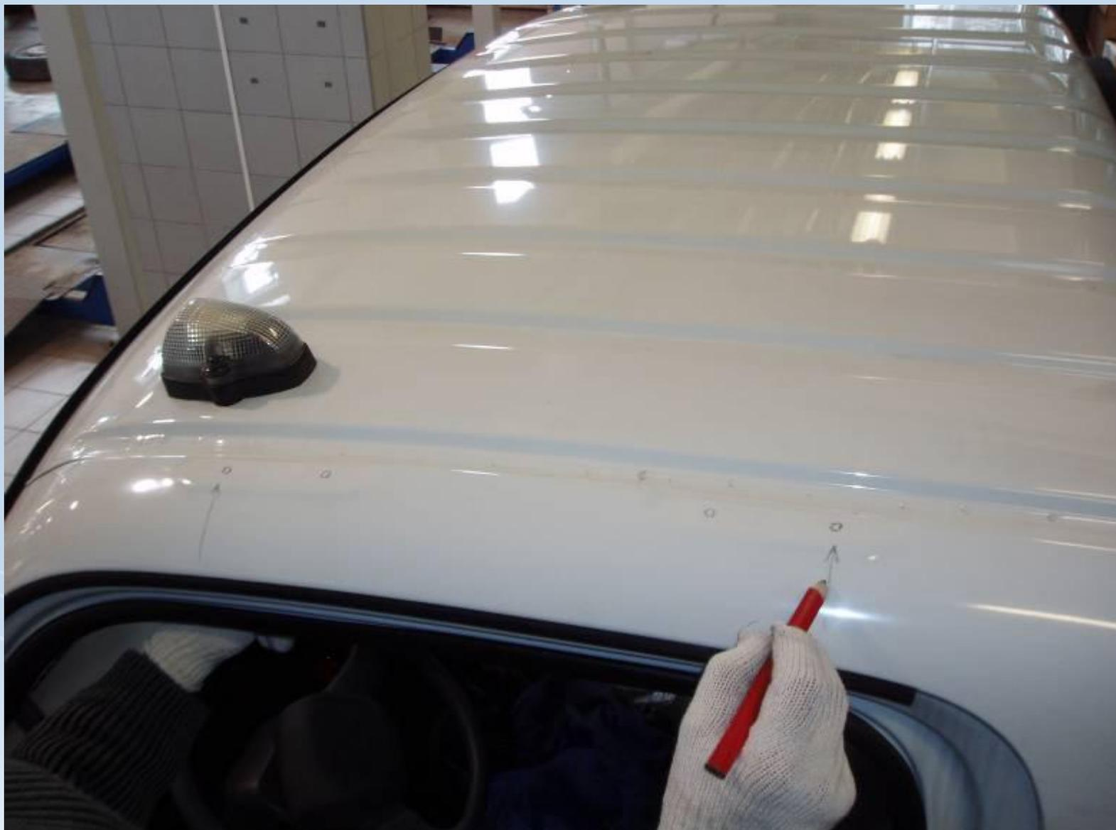
Отметьте на кабине стрелками места отверстий, там уже есть заводская отштамповка, позже вам пригодятся эти метки для ориентирования при сверлении обтекателя.
