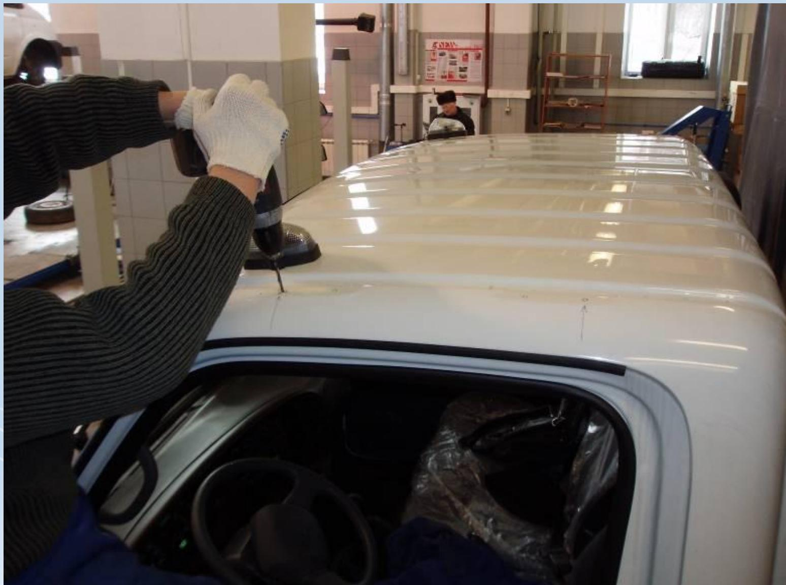
В начале засверлите отверстия сверлом 6мм. (не нажимайте сильно, чтобы не повредить внутреннюю обшивку кабины)
