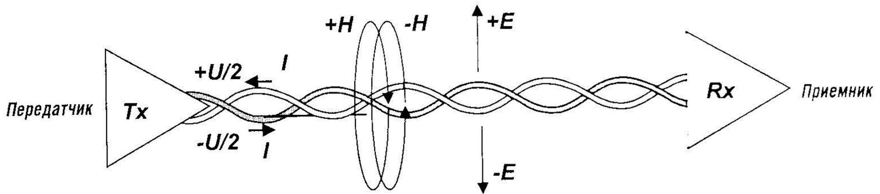
*Напряжение в проводниках равно по величине, но противоположно по знаку. Вследствие этого электрические поля, создаваемые проводниками, гасят друг друга.*
