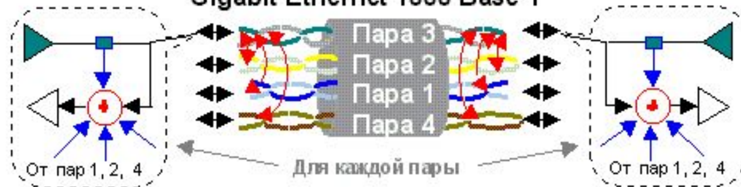
Схема 2. Схема передачи и наводок протоколов Fast Ethernet и Gigabit Ethernet
