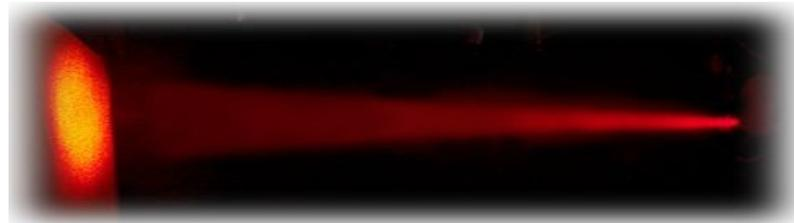
Лазер с мощностью 8 Вт на наноструктуре с 13 КЯ и двумя брэгговскими зеркалами AlAs-AlGaAs
