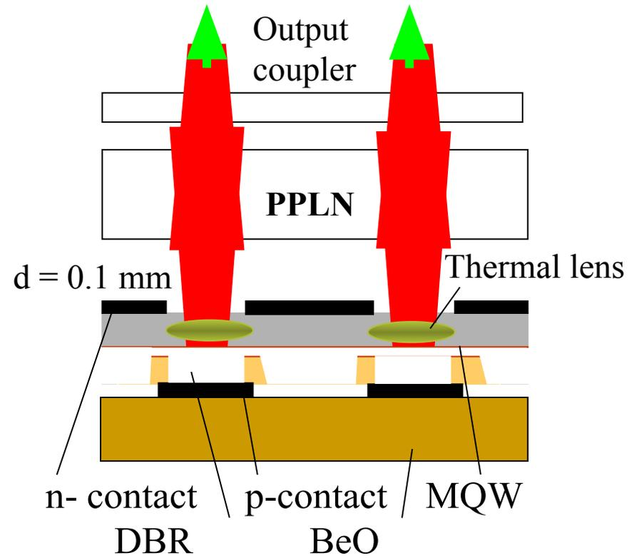
Структура из III-V соединений с резонансно-периодическим усилением
