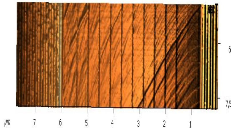
Изображение скола лазера в зондовом микроскопе
