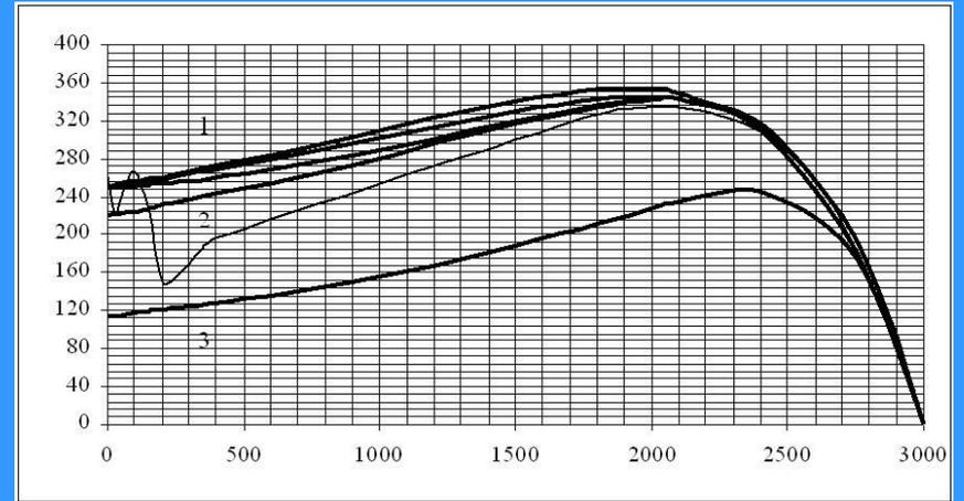
Результаты расчета механических характеристик погружного электрического двигателя
