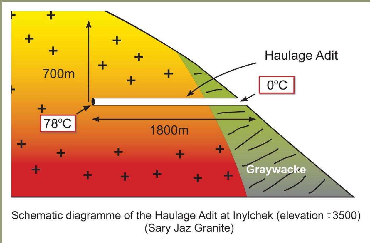
Сверхвысокий вертикальный геотермальный градиент  $> 100^{\circ}\text{C}/\text{km}$
