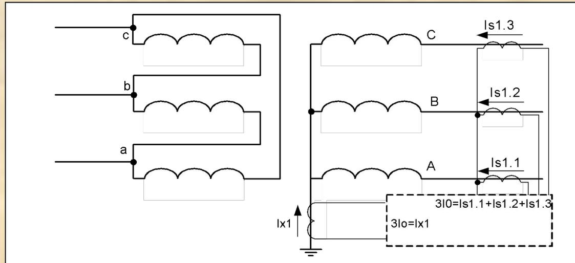
Данная защита определяет замыкания на землю в силовых трансформаторах, нейтраль которых заземлена. Необходимым условием для работы этой защиты является установка ТТ в нейтрали и трёх ТТ в фазах
