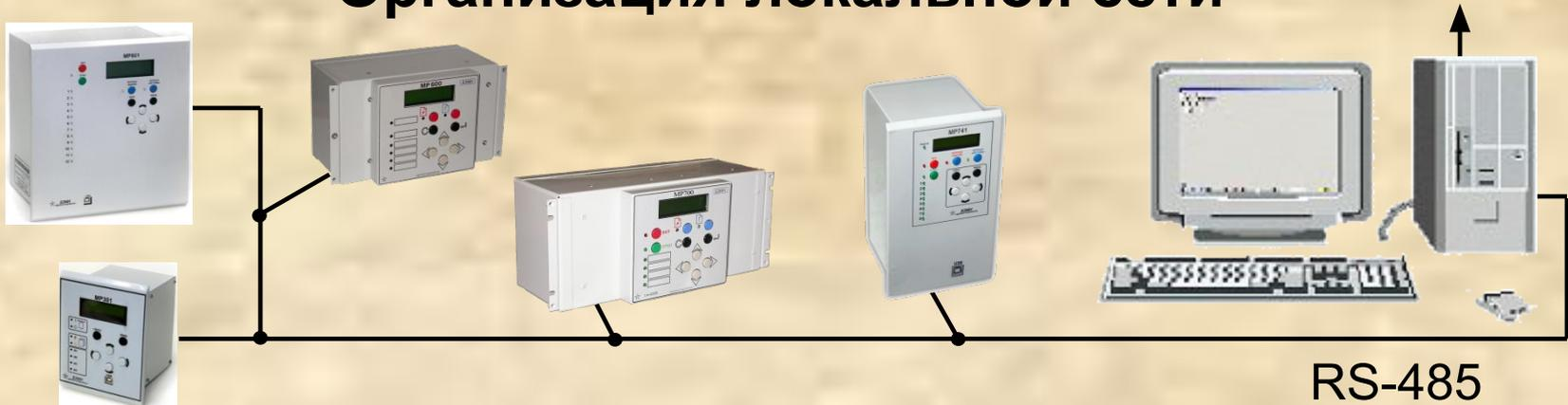
Защиты серии МР имеют интерфейс RS-485, открытый протокол МР-СЕТЬ (аналог MODBUS) и могут быть включены в систему АСУ ТП подстанции. На терминалы МР500, МР600, МР7хх протокол МЭК-870-5-103 может быть установлен по заказу. По локальной сети может быть осуществлена синхронизация устройств по времени.
