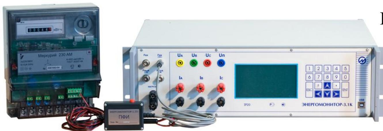
Измерение постоянного и переменного тока до 100 А и
