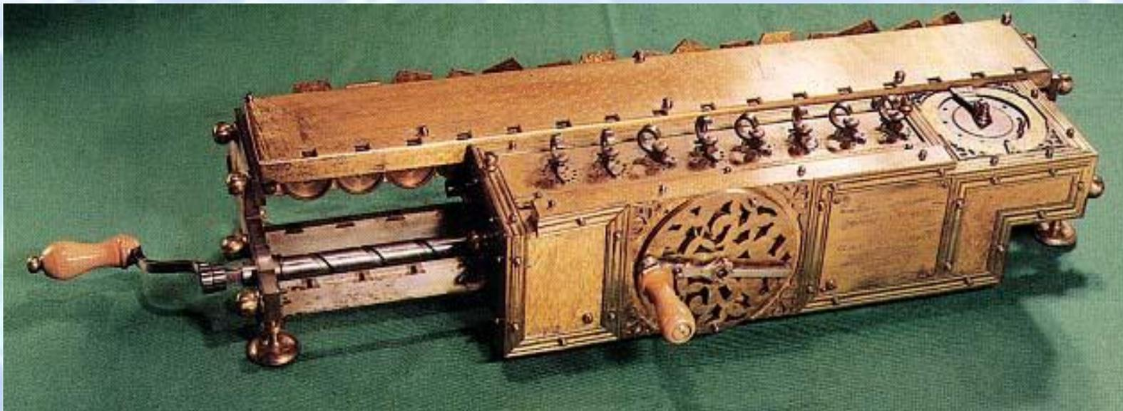
Арифмометр Лейбница (1673 г., реконструкция). Механизм ввода слагаемых размещен спереди на подвижной каретке, его ступенчатые валики вращаются правой рукояткой. Суммирующий механизм расположен сзади, сдвиг каретки производится поворотом левой рукоятки
