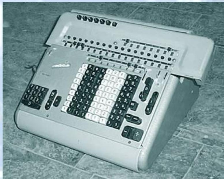
Усовершенствование механического арифмометра продолжалось вплоть до 70-х годов XX века. Были разработаны многочисленные конструкции с ручным и электрическим приводом
