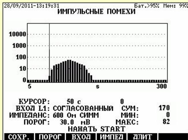
Импульс считается если, полученный шумовой сигнал присутствует в измеряемом диапазоне более, чем **500** наносек
