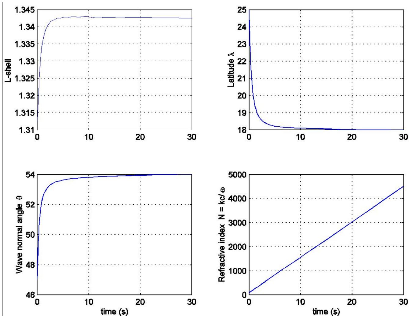
Изменение параметры волны вдоль ее траектории: L-оболочка, широта, вектор волновой нормали и показатель преломления  $N = kc/\omega$  для волны с частотой 300 Гц стартовой с широты  $\lambda_0 = 25^\circ$  и «застревающей» в том же полушарии.
