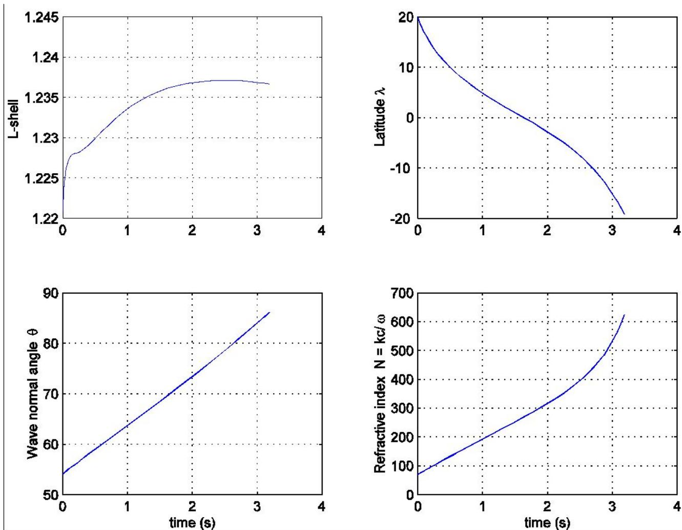
Изменение параметры волны вдоль ее траектории: L-оболочка, широта, вектор волновой нормали и показатель преломления  $N = kc/\omega$  для волны с частотой 200 Гц стартующей с широты  $\lambda_0 = 20^\circ$  и достигающей высоты спутника в противоположном полушарии
