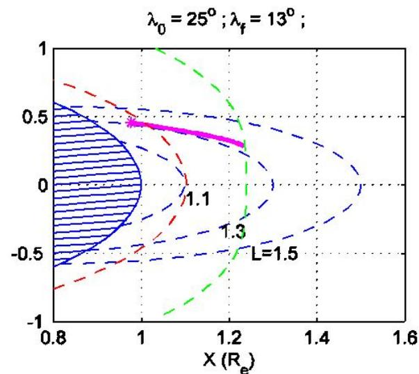
Лучевые траектории для протонных циклотронных волн с частотой 250 Гц и различными начальными широтами
