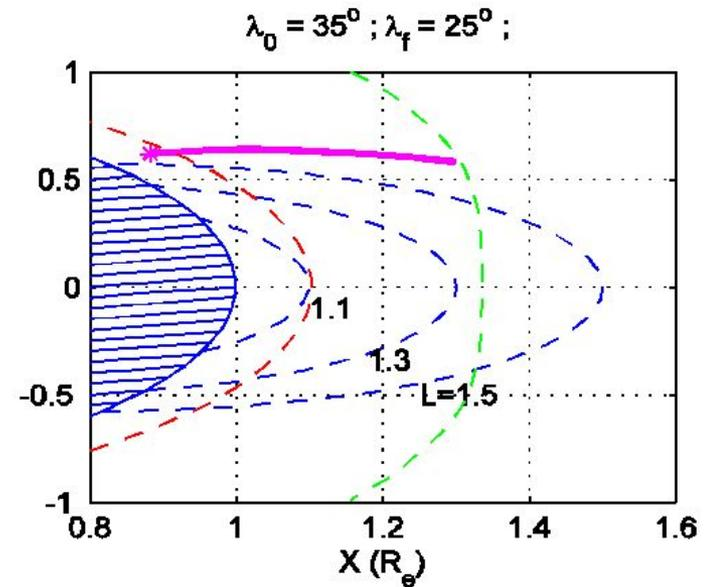
Лучевые траектории для протонных циклотронных волн с частотой 200 Гц и различной начальной широтой.
