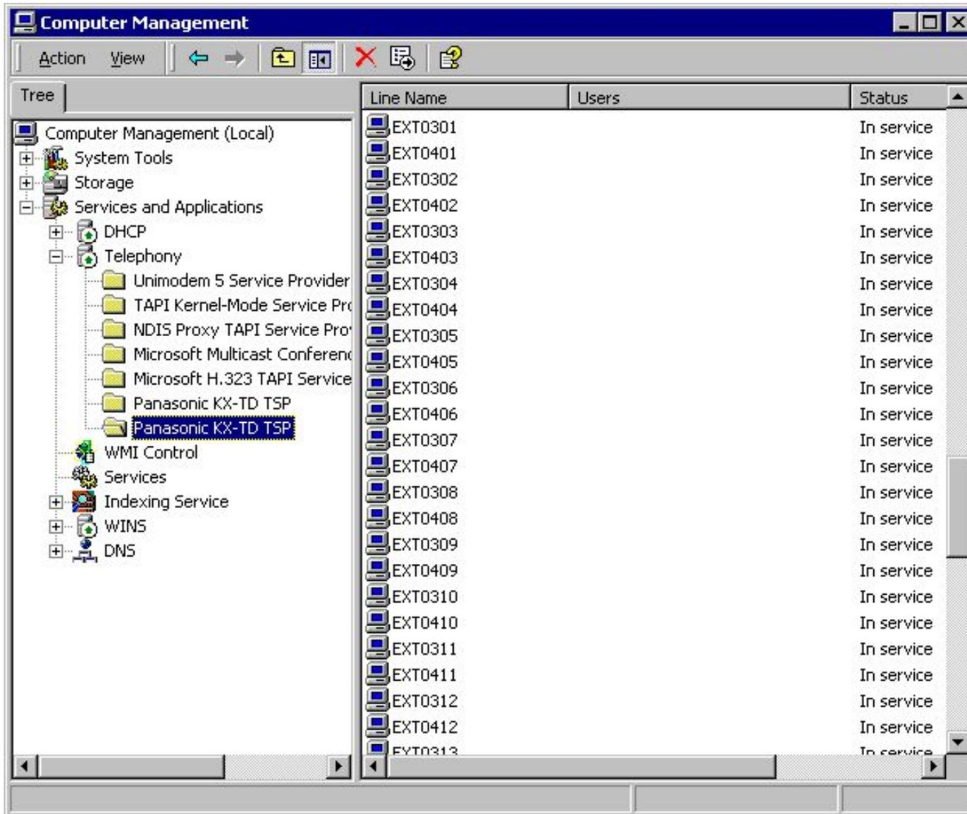
3. Устанавливаем TAPI клиент на компьютере оператора (EXT0102) через командную строку `tcmsetup /c TAPI 1`
