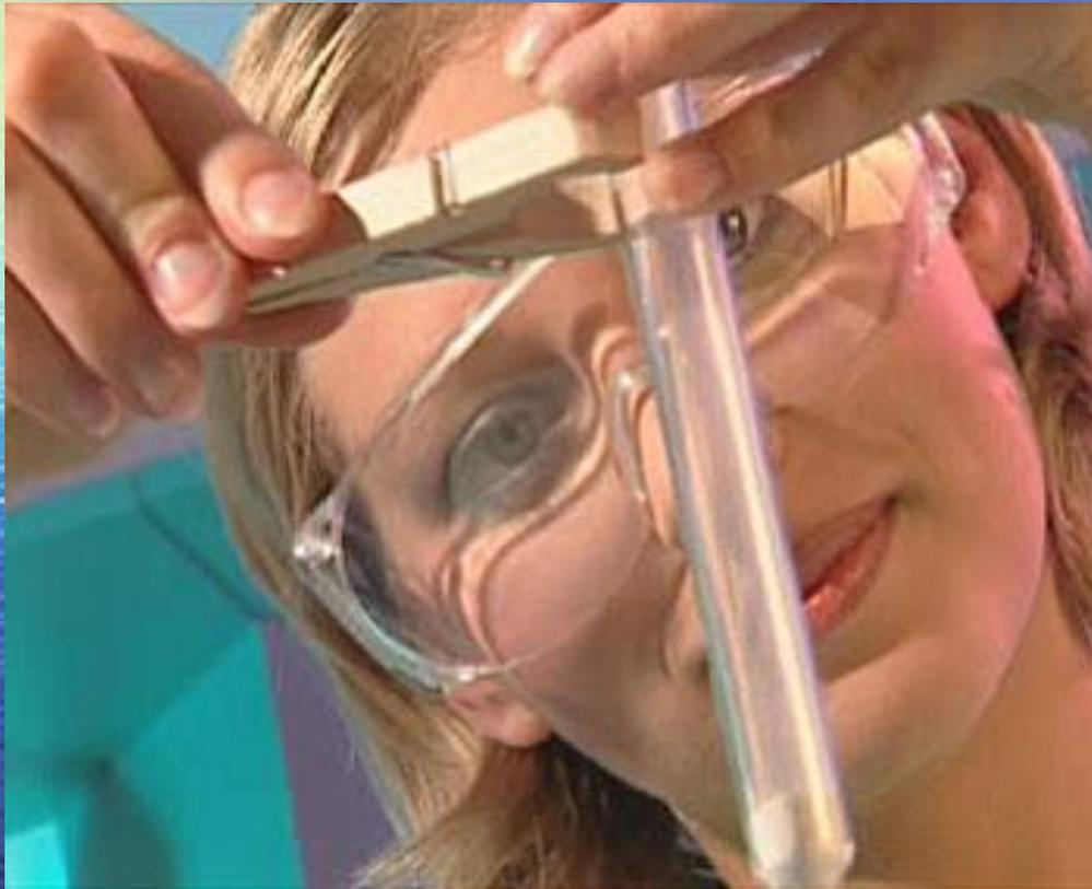
Небольшое количество гипса поместили в термостойкую пробирку. Нагреем пробирку в пламени горелки. На стенках пробирки появляются капли воды
