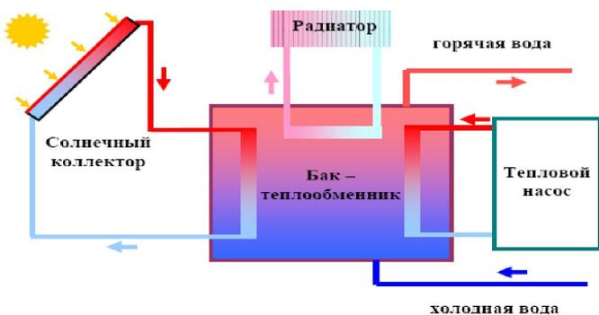
Схема комбинированной системы теплоснабжения
