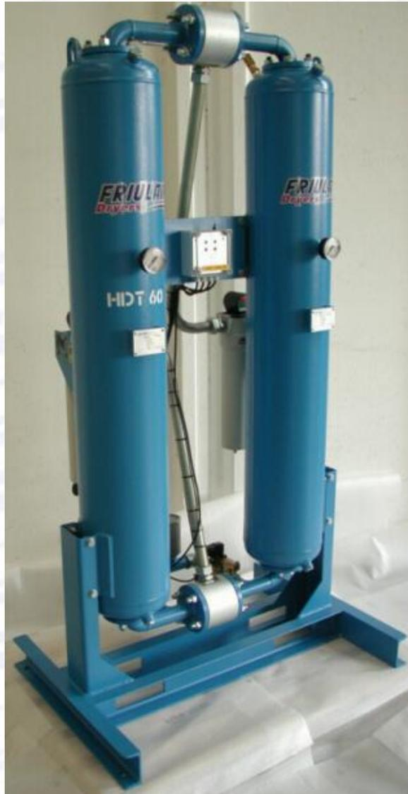
Адсорбционные безнагревные осушители HDT состоят из двух параллельных колонн заполненных адсорбирующим материалом. В одной из колонн сжатый воздух осушается, в то же время, во второй влажной колонне, только что отключившейся от линии, адсорбент восстанавливается. Для этого используется небольшое количество осушенного воздуха.
