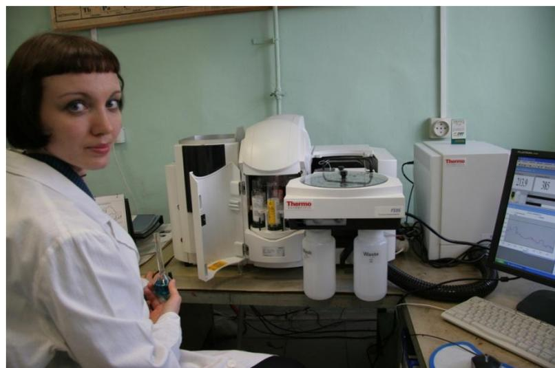
Атомно-абсорбционный спектрометр SOLAAR
