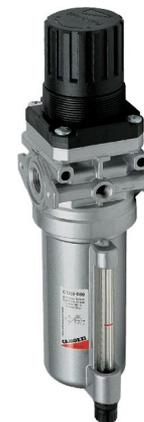
БЛОК ПОДГОТОВКИ ВОЗДУХА – фильтры и регуляторы давления, на входе в упаковочную машину имеется фильтр-регулятор давления для очистки воздуха от влаги, компрессорного масла, твердых частиц, а также для настройки рабочего давления
